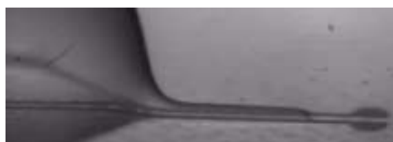
(b) 電圧印加後 1.0s (電極上を液が移動)
